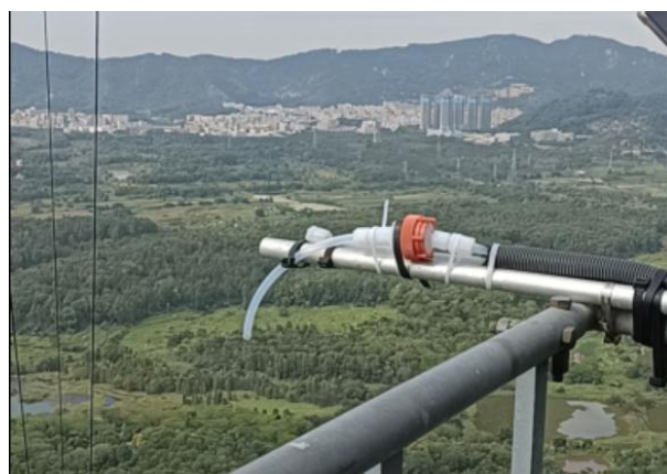
图 10 采样口安装位置示例
